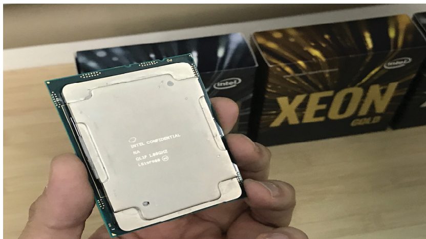
그림 43 인텔 제온 스케일러블 프로세서. 인텔은 미세공정 도입에 곤란을 겪고 있지만 프로세서의 구조를 개선해 데이터센터의 요구사항을 맞춰가고 있다.
