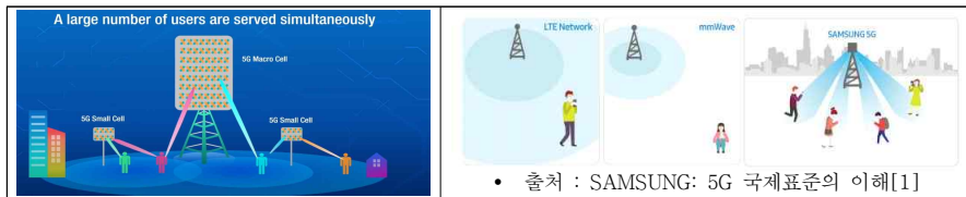
[그림 3] 5G mmWave를 위하여 중요한 기술 : 스텔셀, 빔포밍
