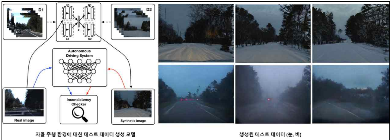
[그림 16. 자율 주행 환경에서 불확실성이 높은 테스트 데이터를 생성해내는 [19]의 모델 및 생성된 데이터의 예]
