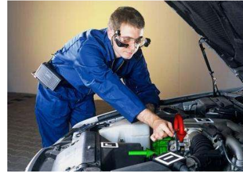
<그림 2-24> 자동차 수리 및 정비에 필요한 정보를 보여 주는 AR 장비
